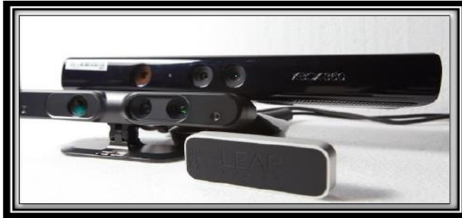
شكل (5) جهاز قياس العمق ثلاثي الأبعاد المقترن بالكاميرا بنظام RGB
