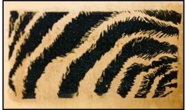
(شكل 10)، تجربة طباعية للباحثة، نقل هيدروجرافيك مائي على جلد مقلوب
